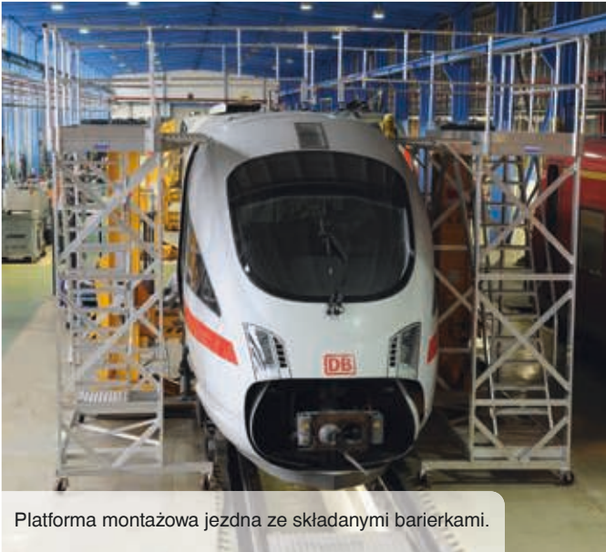
Platforma wysuwana z listwą odbojnikową i składanymi barierkami.
