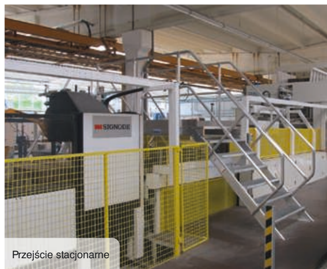
Platforma jezdna ułatwiająca dostęp do urządzenia
