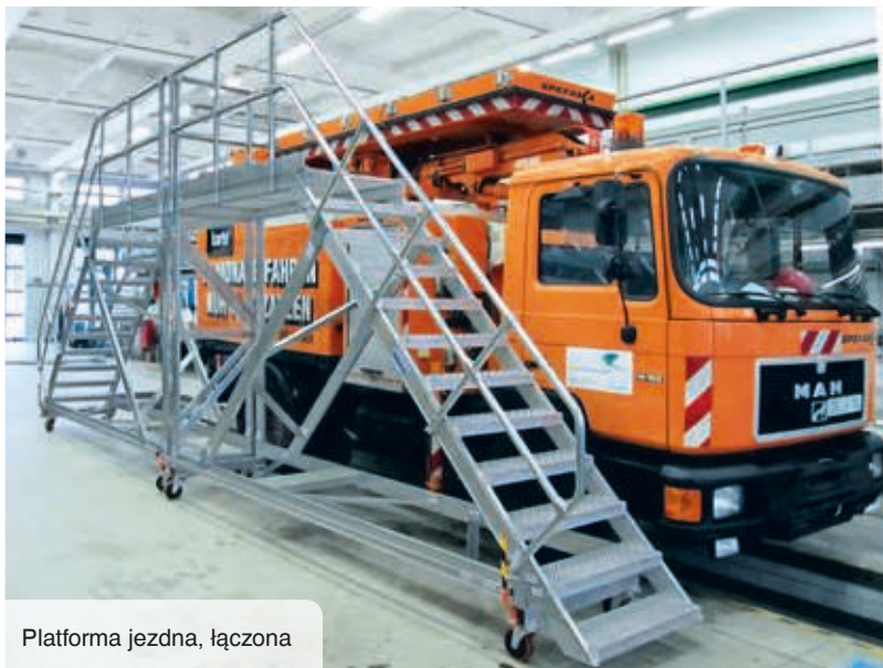
Platforma jezdna ułatwiająca dostęp do urządzenia
